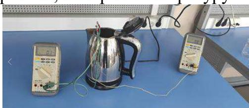
Рисунок 1 – Измерение термоЭДС
